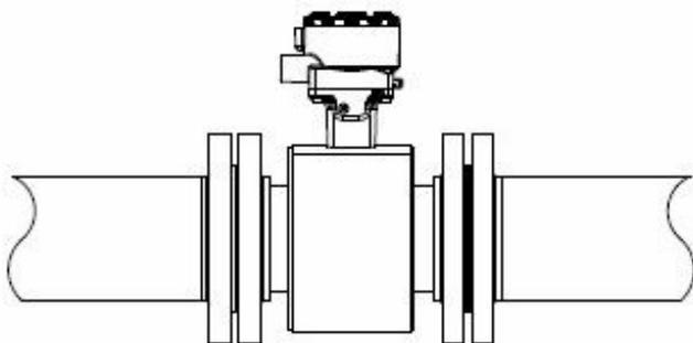
图 5-5: 10 英寸或更大尺寸管道接地装置
