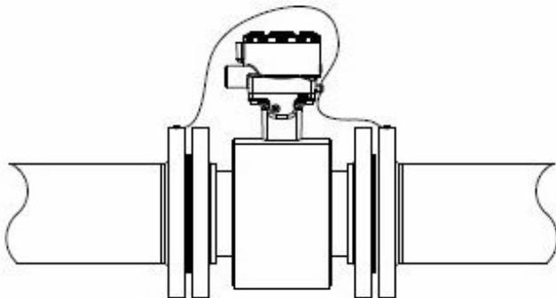
图 5-2: 导电管道中带接地环或衬里保护器的接地装置
