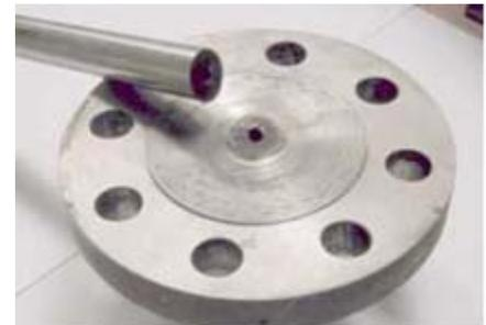
Beispiel für einen Schutzrohr-Abriss aufgrund der durch Wirbel erzeugten Schwingungen.<sup>(2)</sup>
