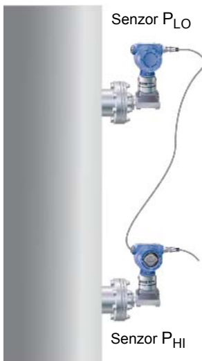
Sl. 1. Okomita instalacija uređaja Rosemount 3051S ERS
