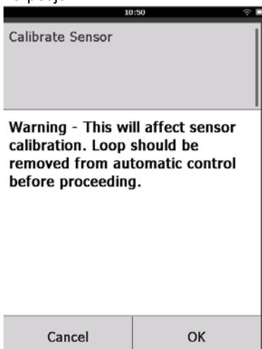
8. Postavite senzor na čist zrak da biste postavili nultu vrijednost očitanja. Ako zrak u okolini sadržava tragove ciljnog plina ili drugih plinova (primjerice ugljikov monoksid iz ispuha motora) koji mogu ometati postavljanje nulte vrijednosti uređaja, učinite sljedeće:
