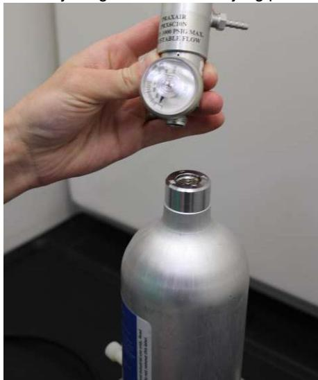
12. Priklučite kalibracijsku cijev (PVC cijevi,  $\frac{3}{16}$  inča unutarnjeg promjera,  $\frac{5}{16}$  inča vanjskog promjera) iz regulatora na izvoru ciljnog plina na ulaz IP filtra na dnu modula senzora plina Rosemount 628.
