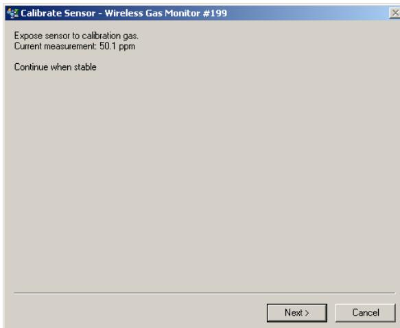
17. Pričekajte da bežični konfigurator AMS izvrši kalibraciju.
