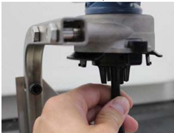
13. Pustite ciljni plin iz izvora ciljnog plina. Preporučuje se protok od 1,0 litre po minuti da bi se osiguralo neprekidno očitanje senzora.
