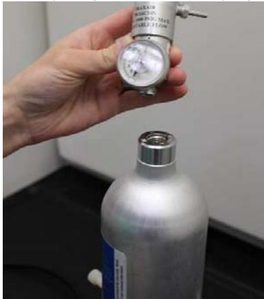
16. Priklučite kalibracijsku cijev (PVC cijevi,  $\frac{3}{16}$  inča unutarnjeg promjera,  $\frac{5}{16}$  inča vanjskog promjera) iz regulatora na izvoru ciljnog plina na sklop IP filtra modula senzora plina Rosemount 628 (broj dijela 00628-9000-0001).
