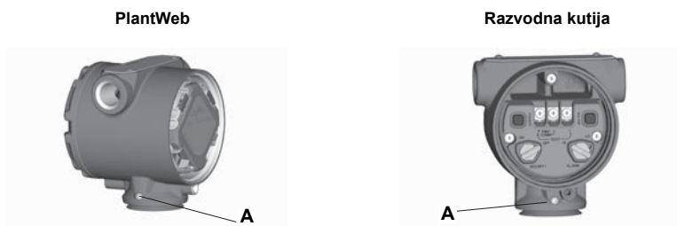
A. Vijak sklopa za zakretanje kućišta ( \frac{3}{32} inča)
