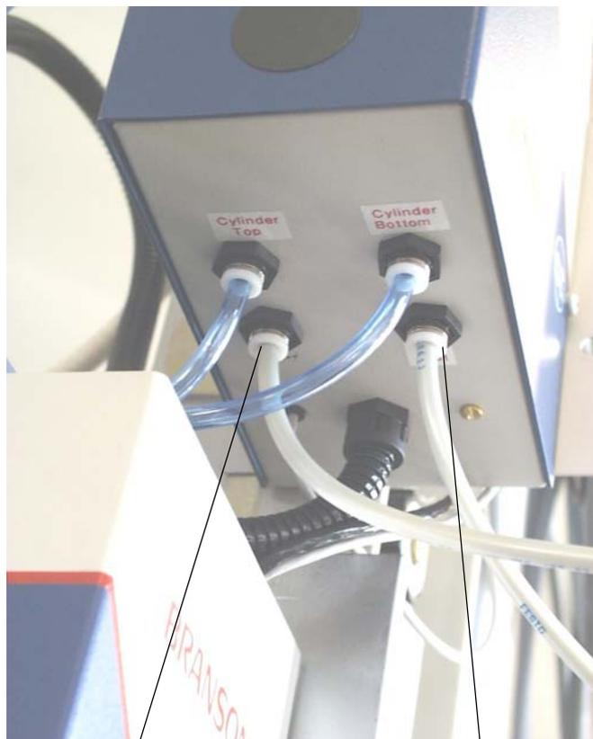
Entrée d'air du panneau pneumatique « régulé »
