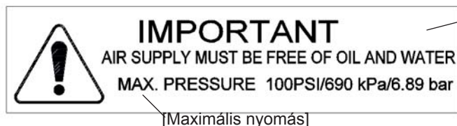
2-3. ábra Figyelmeztetések a 2000X sorozatú előtölőegységen - sűrített levegő bevezetés
