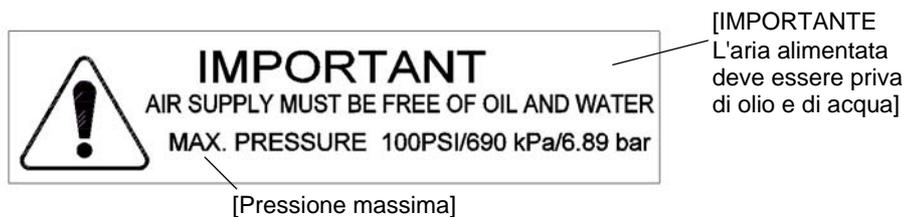
Fig. 2-4 Avvertenze di sicurezza sul lato frontale dell'unità di avanzamento
