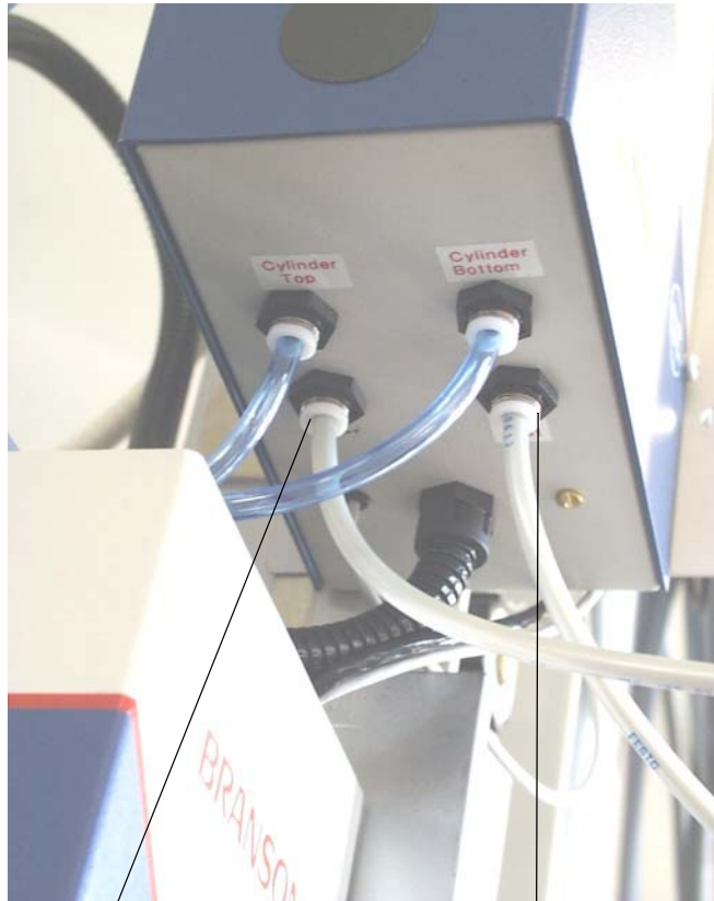
Fig. 5-20 Unidad neumática aodm vista desde abajo
