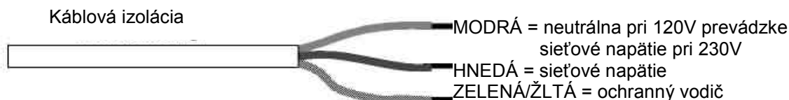
Obr. 5.-5 Farebné označenie sieťového kábla podľa medzinárodného štandardu
