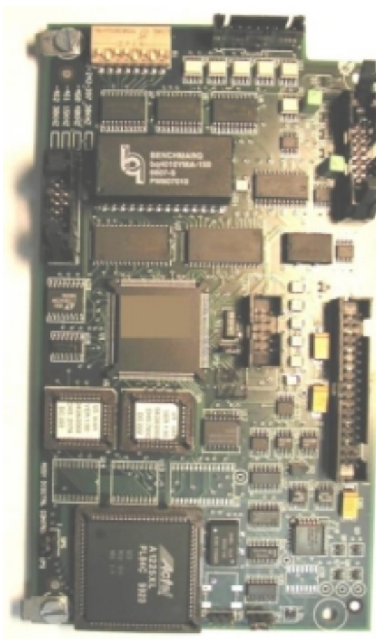
Obr. 5-7 Poloha prepínacieho bloku DIL, typ 1
