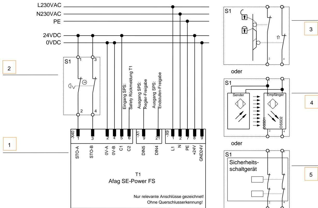
Die Sicherheitsfunktion „Sicher abgeschaltetes Moment“ (STO) kann durch verschiedene Geräte angefordert werden. Der Schalter S1 kann z.B. ein Not-Halt-Schalter, ein Schutztür-Schalter, ein Lichtgitter oder ein Sicherheitsschaltgerät sein. Die Sicherheitsanforderung erfolgt 2-kanalig über den Schalter S1 und führt zum 2-kanaligen Abschalten der Endstufe. Ist die Abschaltung der Endstufe erfolgt, wird dies durch den potentialfreien Kontakt C1/C2 ausgegeben.
