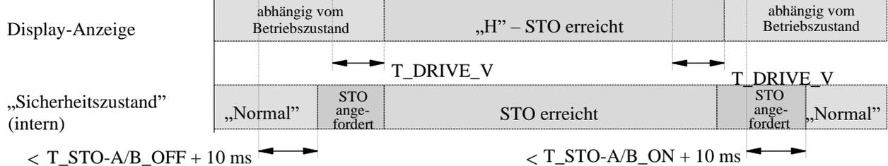
**Abbildung 3: Basis-Zeitverhalten beim Aktivieren und Deaktivieren der Sicherheitsfunktion STO**
