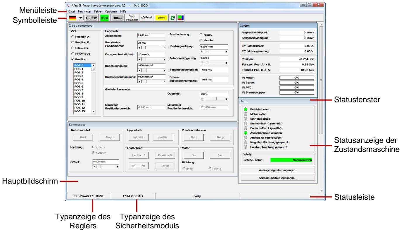
Abbildung 9: Typanzeige des Sicherheitsmoduls und erweitertes Status-Fenster
