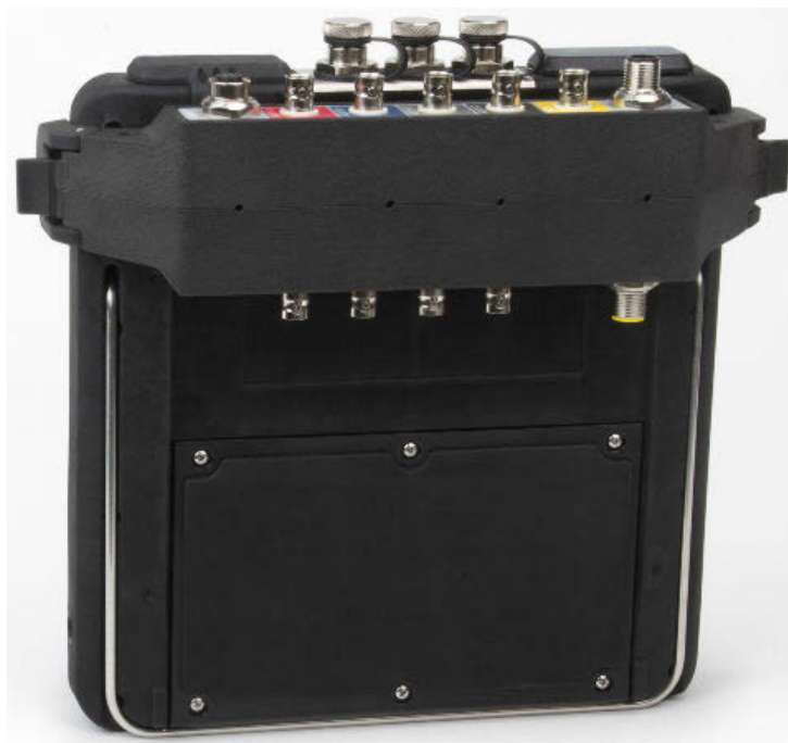
Figur 1-5: Ingångsadaptern med fyra kanaler ansluten till CSI 2140 utan gränssnittskabel
