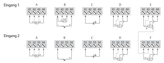
A. 2 w / 3 w / 4 w Widerstandsthermometer oder lin. R
