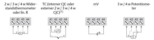
(1) Bei Verwendung des Thermoelement-Eingangs kann der Messumformer entweder für konstante, interne oder externe CJC über einen Pt100- oder Ni100-Sensor konfiguriert werden. Dies muss während der Konfiguration des Geräts ausgewählt werden.
