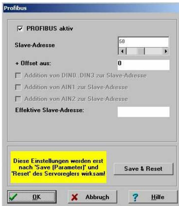
Abbildung 8.1: Einstellung der Betriebsparameter
