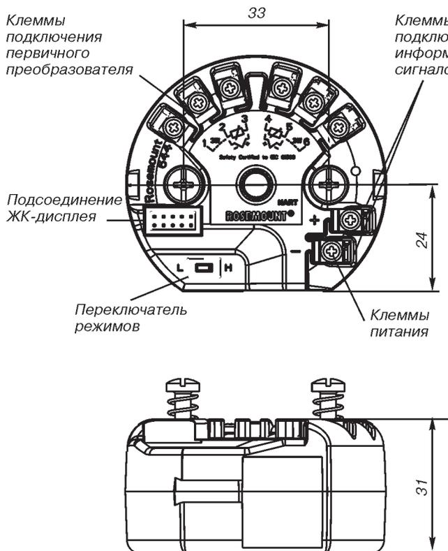
Рис. 1. HART преобразователь показан с невыпадающими винтовыми клеммами.
