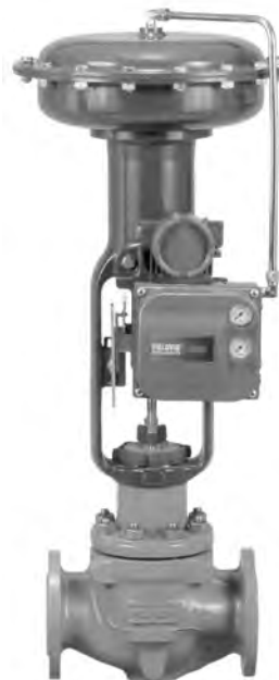
1 pav. Vožtuvas „Fisher“ EZ su pavaros mechanizmu 657 ir skaitmeniniu vožtuvo reguliatoriumi DVC6000
