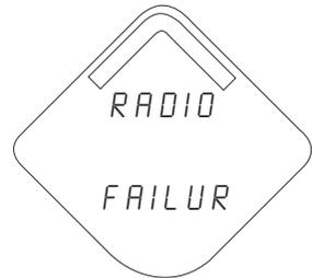
**Diagnosetaste-Bildschirm 8:** Das Gerät kann möglicherweise nicht mit dem Sender kommunizieren oder der Sender weist einen internen Fehler auf. In diesem Status kann es vorkommen, dass das Gerät weiterhin funktioniert und HART Daten ausgibt.
