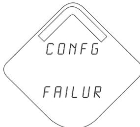
**Diagnosetaste-Bildschirm 9.1:** Die Konfiguration des Messumformers ist ungültig, sodass kritische Betriebsfunktionen des Geräts beeinträchtigt sein können. Den Status der erweiterten Konfiguration überprüfen, um zu identifizieren, welche(s) Konfigurationselement(e) korrigiert werden muss/müssen.
