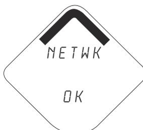
**Diagnosetaste-Bildschirm 4:** Das Gerät ist mit einem Netzwerk verbunden, wurde vollständig konfiguriert und hat mehrere übergeordnete Geräte.
