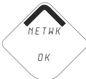
**Diagnosetaste-Bildschirm 4.9:** Das Gerät ist mit einem Netzwerk verbunden, wurde vollständig konfiguriert und hat mehrere übergeordnete Geräte.
