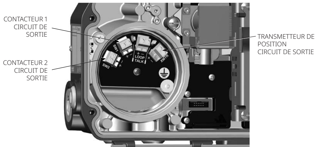
Figure 25. Options d'E/S : transmetteur de position de 4 à 20 mA et deux contacteur à contact sec à semi-conducteurs
