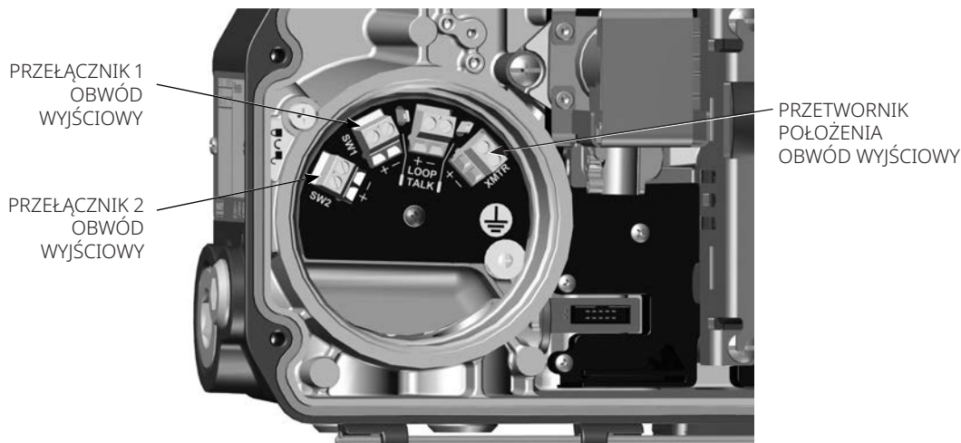
Rysunek 25. Opcje WE/WY: Przetwornik położenia od 4 do 20 mA i dwa przełączniki beznapięciowe półprzewodnikowe
