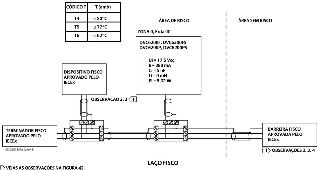
Figura 41. Esquema de circuito - FIELDVUE DVC6205f, DVC6205p, e DVC6215
