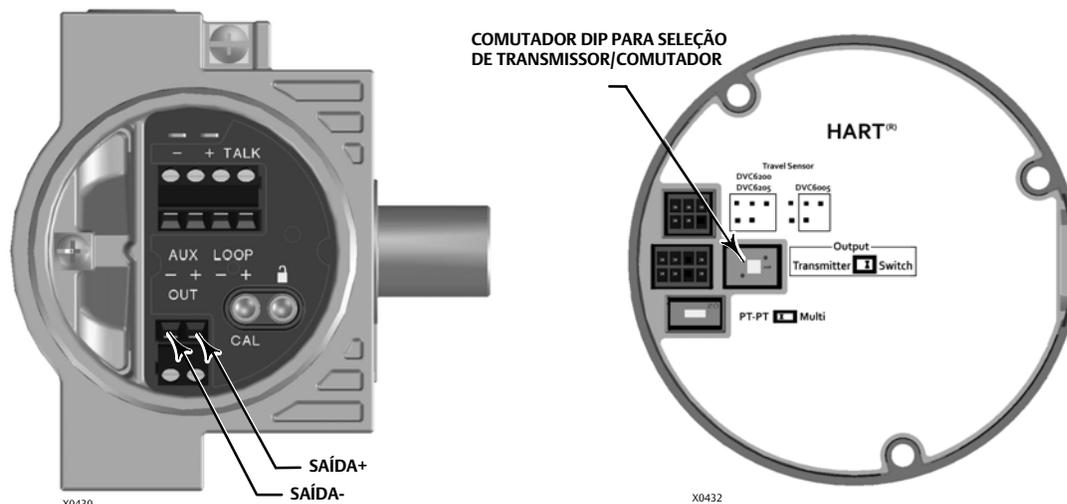
O circuito do transmissor de posição deriva sua força de operação do sistema de controle do canal de entrada da mesma maneira que de um transmissor de 2-fios.
