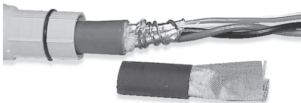
Kuva 3-7: Suojattu lämpökutiste peittää paljastuneet suojajohtimet
