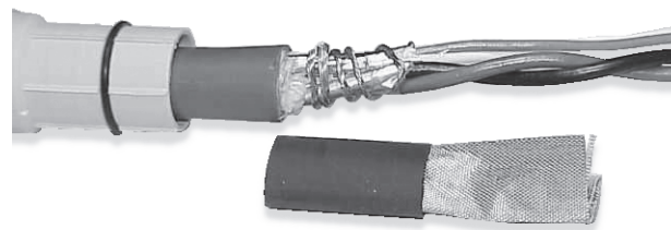
Abbildung 3-6: Beilaufitzen der Abschirmung zweimal um die freigelegte Folie gewickelt
