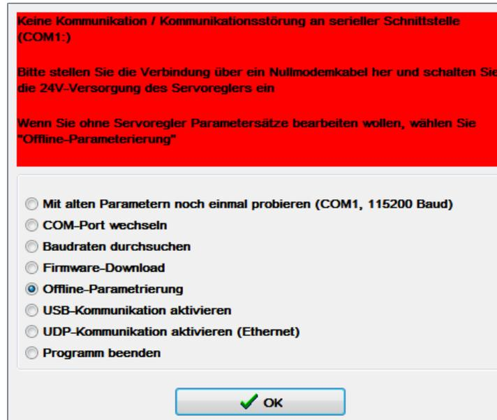
Abbildung 14: Offline Parametrierung
