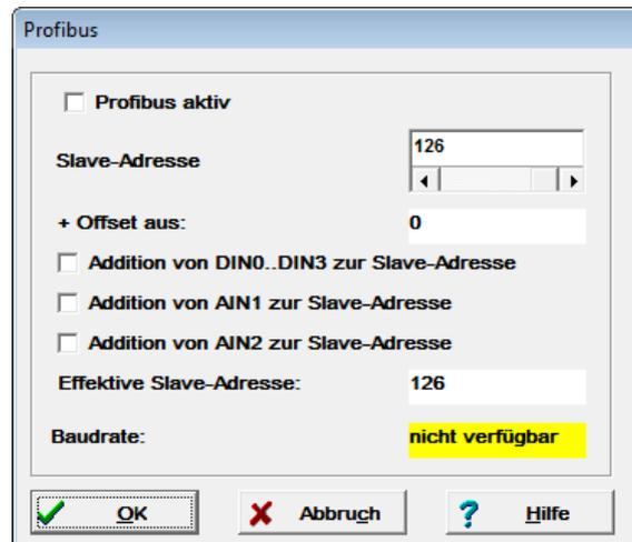
Die PROFIBUS-DP-Kommunikation kann über das Feld **Profibus aktiv** ein- und ausgeschaltet werden.
