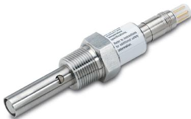
Rosemount 400/400VP Kontakt-Leitfähigkeitssensoren sind für die Messung der elektrolytischen Leitfähigkeit bei Anwendungen in sauberem Wasser bestimmt. Sie können diese Sensoren mit einem 0,01/cm, 0,1/cm oder 1,0/cm konfigurieren, um unterschiedliche Leitfähigkeitsstufen zu erfüllen. Die Sensoren sind entweder mit integriertem Kabelanschluss oder Variopol (VP6)-Steckverbinder erhältlich. Variopol sind separat zu bestellen (siehe [Zubehör](#)).
