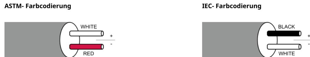
Thermoelemente vom Typ J sind aus Eisen und Konstantan gefertigt, mit einem potenziellen Temperaturbereich von -40 bis 1 400 °F (-40 bis 760 °C) und einer Empfindlichkeit von ca. 50 µV/°C. Thermoelemente vom Typ J werden bei Temperaturen unter 32 °F (0 °C) brüchig und eignen sich für den Einsatz in Vakuum oder reduzierender und inerter Atmosphäre. Diese Thermoelemente haben beim Einsatz in oxidierenden Atmosphären eine reduzierte Lebensdauer.
