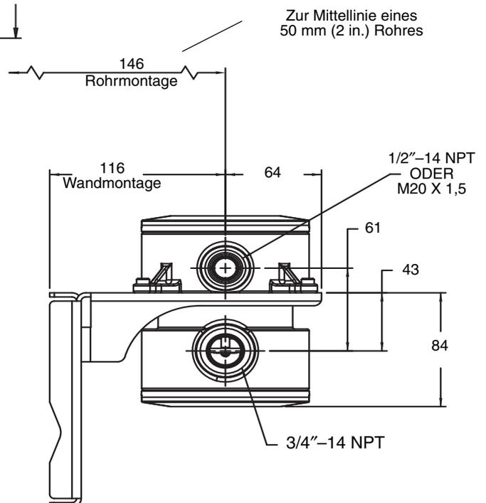
*Diese Abmessungen gelten nur für einen extern vom Sensor installierten Core Prozessor. Die Abmessungen eines integriert am Sensor montierten Core Prozessors finden Sie in den Sensor Spezifikationen.*
