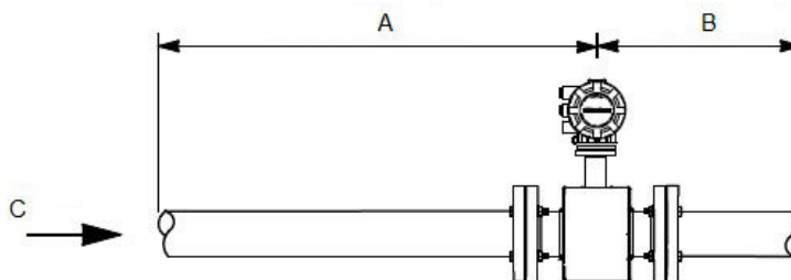
Abbildung 1: Gerade Ein- und Auslaufstrecken auf der Grundlage des Rohrdurchmessers
