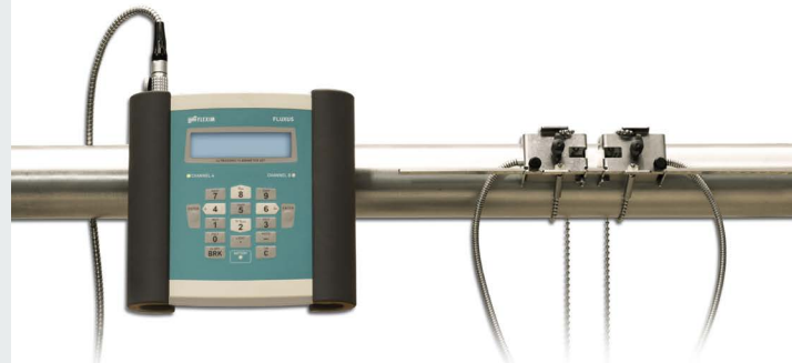
Messung mit Sensoren, montiert mit Anklemschuhen, und mit Durchflussmessumformer, befestigt mit der QuickFix-Rohrbefestigung
