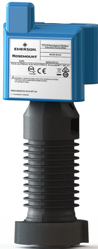
Os sensores wireless Permasense da Rosemount fornecem medição direta da espessura da parede, a indicação mais precisa da integridade do ativo. O transmissor utiliza processamento de sinal patenteado para lidar com a rugosidade da superfície interna causada por alguns mecanismos de corrosão e o melhor material da classe e compensação de temperatura. Esses recursos se combinam para oferecer repetibilidade de medição e sensibilidade líderes do setor em condições de campo.
