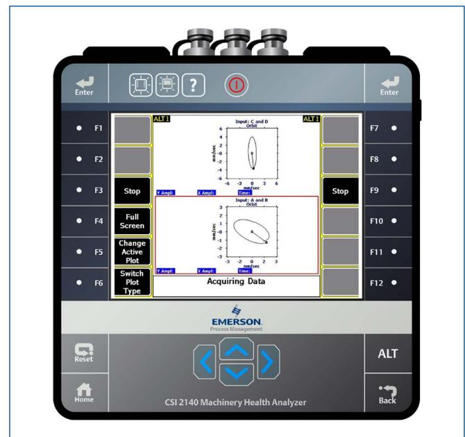
Surveillance double orbites de deux paliers lisses de turbine, ventilateur ou autres équipements critiques pour déterminer si le démarrage peut continuer.
