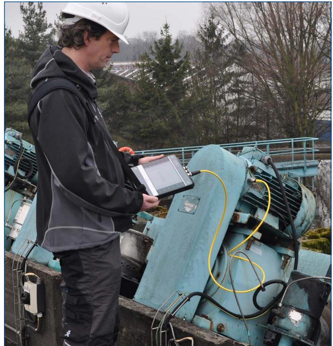
*L'analyseur d'état de santé des machines permet une prise de mesures et une analyse avancée plus rapide et plus efficace.*
