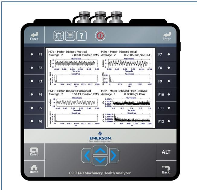
Utilisez le capteur triaxial à aimant intégré breveté d'EMERSON, pour prendre des mesures dans trois directions simultanément. Ces données que l'on examine parallèlement aux données PeakVue™ permettent la détection précoce de défaut de roulement ou d'engrenage.
