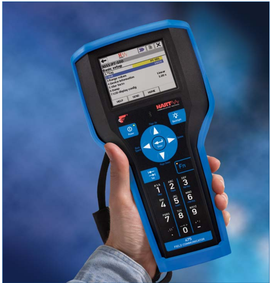
475 现场通讯器适用于所有供应商的 HART 及 FOUNDATION fieldbus 注册设备。
