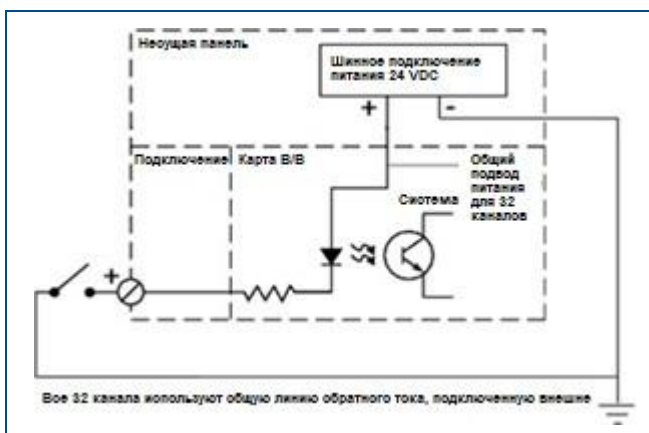
Упрощенная цепь и схема подключения карты DI, 32 канала, 24 VDC, сухой контакт.
