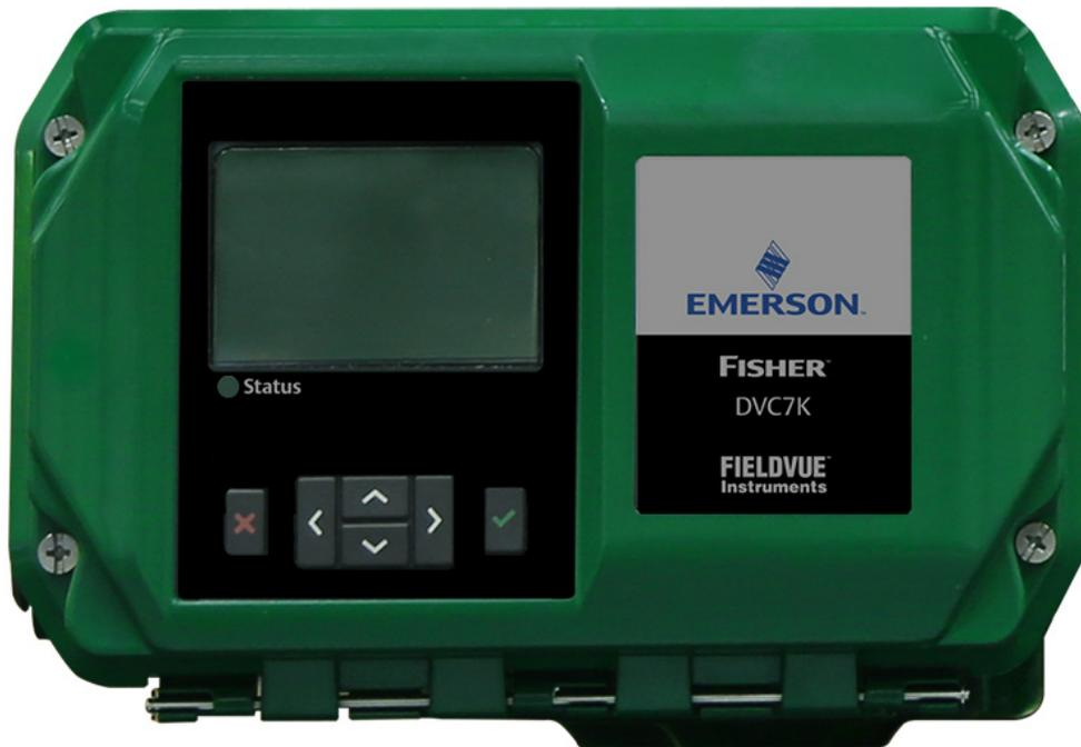
FIELDVUE DVC7K 디지털 밸브 컨트롤러는 신뢰할 수 있고 직관적이며, 플랜트의 성능을 최적화할 수 있는 진단 기능을 갖추고 있습니다. 본 제품은 4~20mA 입력 신호를 밸브의 액추에이터를 제어하는 공압 출력 신호로 변환합니다. 사용하기 쉬운 로컬 사용자 인터페이스(LUI)를 사용하여 설정 및 구성 절차를 수행하고 밸브 상태를 확인하며 Advice at the Device™. 받습니다. 인터페이스는 몇 번의 버튼 조작만으로 여러 언어를 지원하도록 구성할 수 있습니다.
