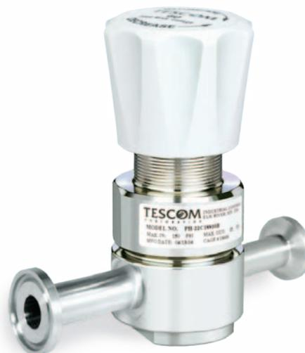
Die TESCO-Serie PHE22 ist Teil unserer Pharmpure™-Produktreihe. Die kompakten, einstufigen Reinstgasregler entsprechen der USP-Klasse VI und sind BPE-zertifiziert und damit geeignet für Spezialgase, korrosive und pyrophore Gase bei  $< 142$  slpm. Die diffusionsdichte Metallmembranabdichtung stellt Gasreinheit und Dichtigkeit sicher.
