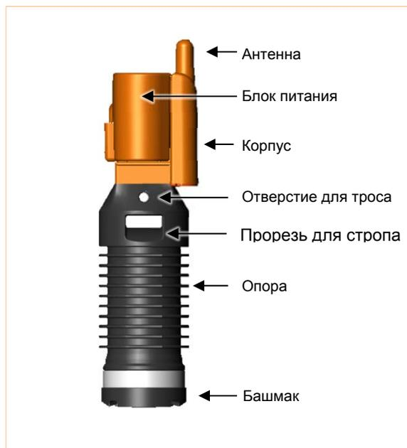
После установки датчик обменивается данными со шлюзом, заданным при установке, а также с другими, ранее установленными, датчиками, которые приписаны к этому же шлюзу. Эти датчики образуют беспроводную mesh-сеть. Управление mesh-сетью осуществляется шлюзом, который выбирает оптимальный путь передачи данных от датчика шлюзу. Затем шлюз отправляет эти данные в базу данных Permasense. Конечный пользователь может просмотреть данные от всех датчиков через интерфейс браузера Permasense Data Manager.
