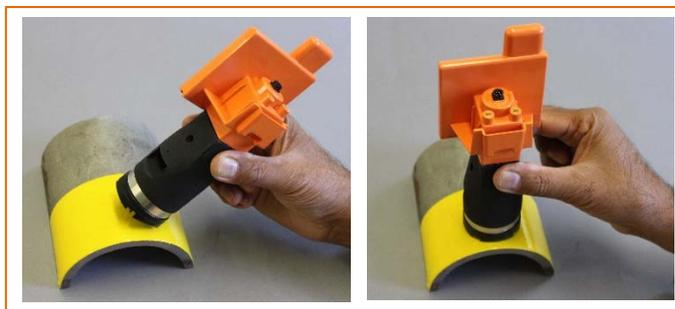
4. Отрежьте строп на требуемую длину. Она зависит от диаметра трубы. Если диаметр трубы равен D см / дюймов, приблизительную длину можно вычислить по формуле  $3 \times (D + 10)$  см (или  $3 \times (D + 4)$  дюймов).
