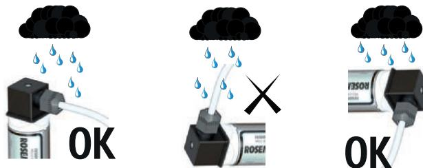
Kiinnitä tulpan suojuksen tulpan ruuvilla ja aluslevyllä ja kiristä kaapelitiiviste.
