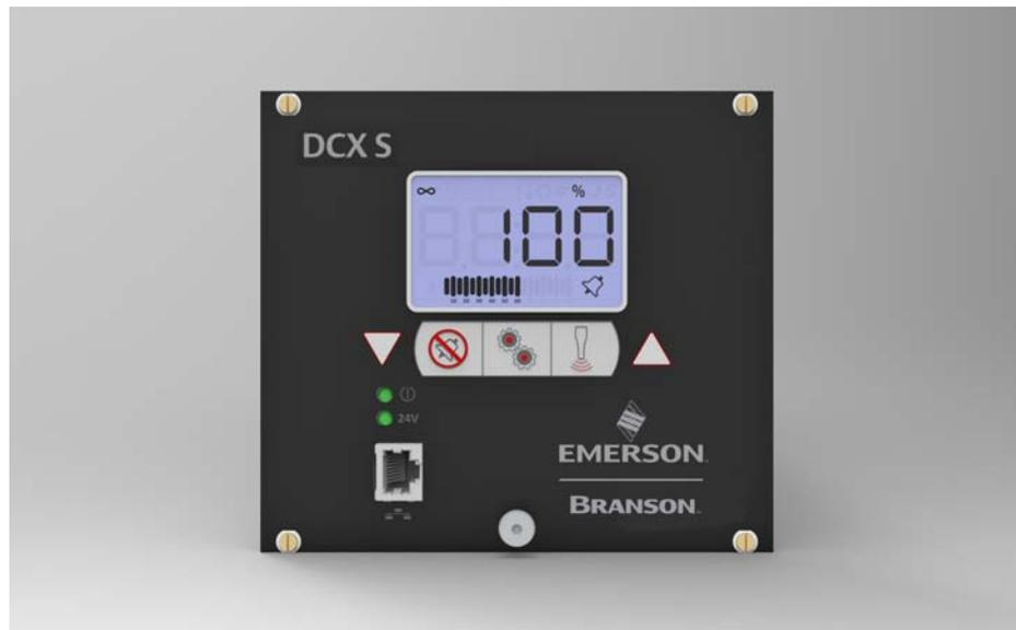
L'Alimentation électrique DCX S génère une énergie à ultrasons par le biais d'un convertisseur à ultrasons pour le soudage de plastiques. Plusieurs modèles sont disponibles en fonction de la fréquence désirée (par exemple 20 kHz) et de la plage de puissance recherchée (par ex. 4,0 kW). L'alimentation électrique contient également un module de contrôleur sur base de microprocesseur pour la commande et la surveillance des opérations de soudage.
