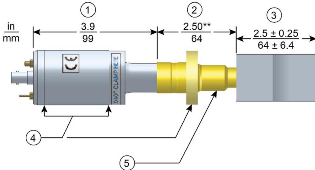
**Tableau 6.9** Convertisseur / booster / sonotrode 40 kHz
