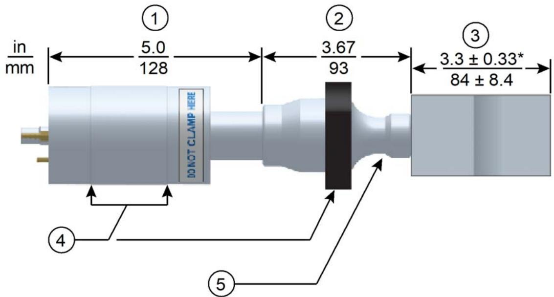
**Tableau 6.6** Convertisseur / booster / sonotrode 30 kHz
