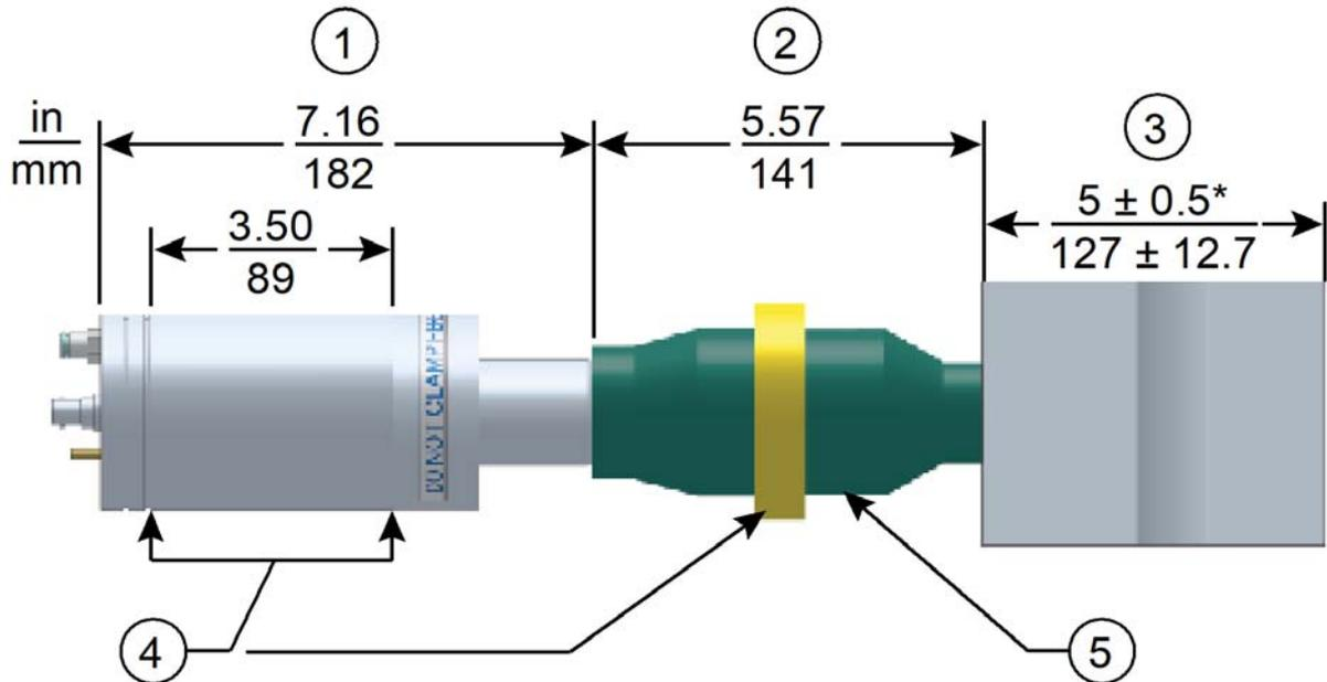
**Tableau 6.3** Convertisseur / booster / sonotrode 20 kHz
