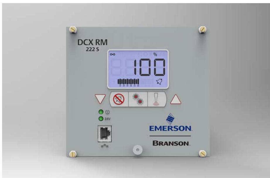
L'Alimentation électrique DCX RM S génère une énergie à ultrasons par le biais d'un convertisseur à ultrasons pour le soudage de plastiques. Plusieurs modèles sont disponibles en fonction de la fréquence désirée (par exemple 20 kHz) et de la plage de puissance recherchée (par ex. 4,0 kW). L'alimentation électrique contient également un module de contrôleur sur base de microprocesseur pour la commande et la surveillance des opérations de soudage.
