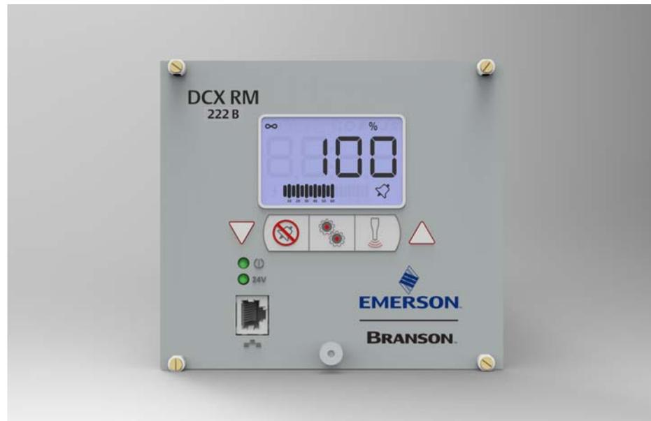
L'Alimentation électrique DCX RM B génère une énergie à ultrasons par le biais d'un convertisseur à ultrasons pour le soudage de plastiques. Plusieurs modèles sont disponibles en fonction de la fréquence désirée (par exemple 20 kHz) et de la plage de puissance recherchée (par ex. 4,0 kW). L'alimentation électrique contient également un module de contrôleur sur base de microprocesseur pour la commande et la surveillance des opérations de soudage.
