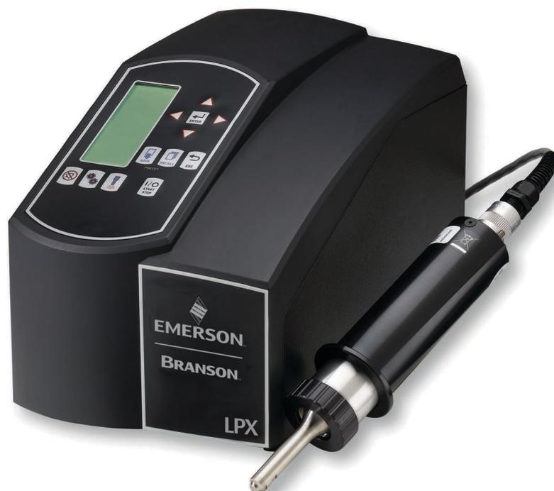
L'alimentation électrique LPX est un dispositif d'amplitude constante. Lorsque la charge ou la pression sur la face de la sonotrode diminue, l'alimentation électrique développe plus de puissance afin de maintenir l'amplitude réglée. Lorsque la sonotrode fonctionne à l'air, une puissance minimale est requise pour maintenir l'amplitude.
