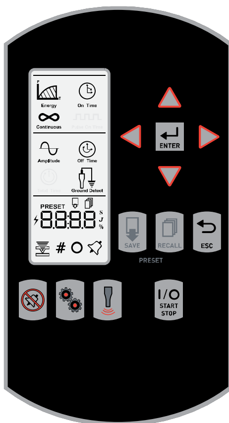
Obrázok 6.1 Používateľské rozhranie napájacieho zdroja LPX
