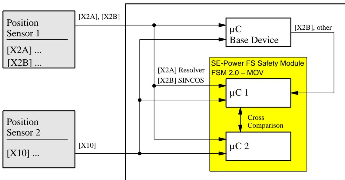
Abbildung 5: Auswertung der Positionssensoren auf dem Sicherheitsmodul
