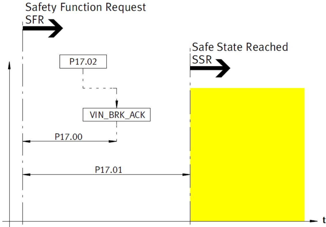
Abbildung 18: Ablaufdiagramm SBC
