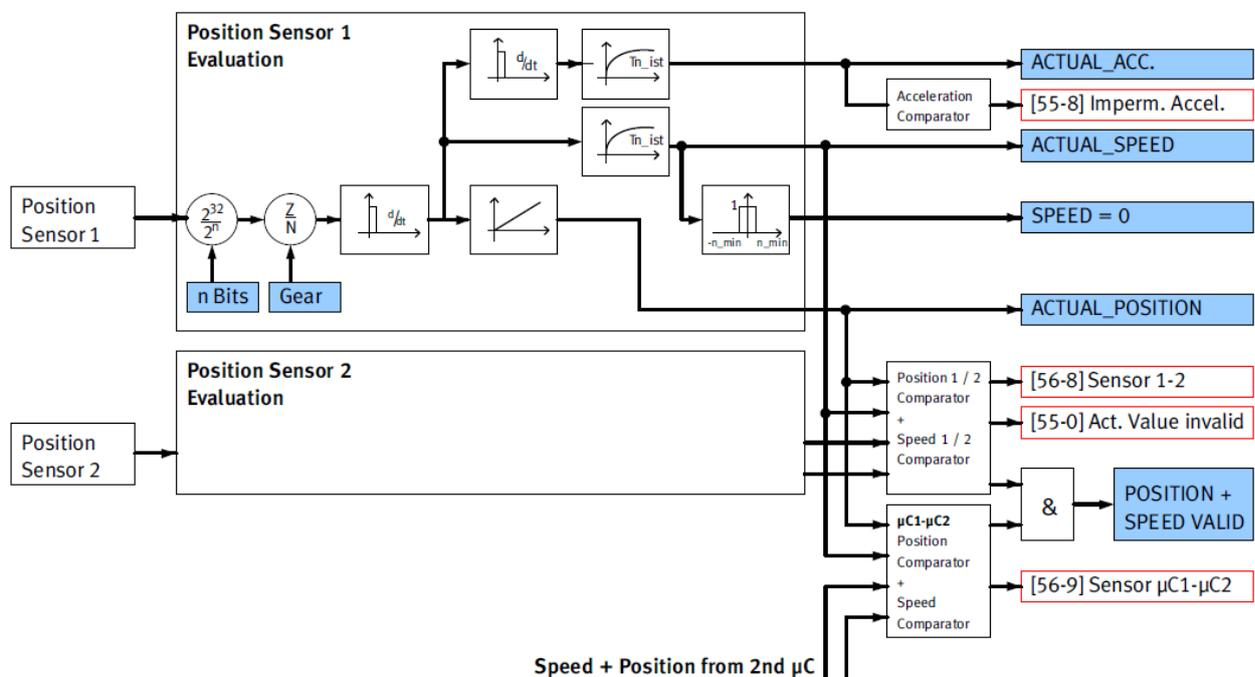
Abbildung 6: Berechnung der Geschwindigkeit und der Beschleunigung
