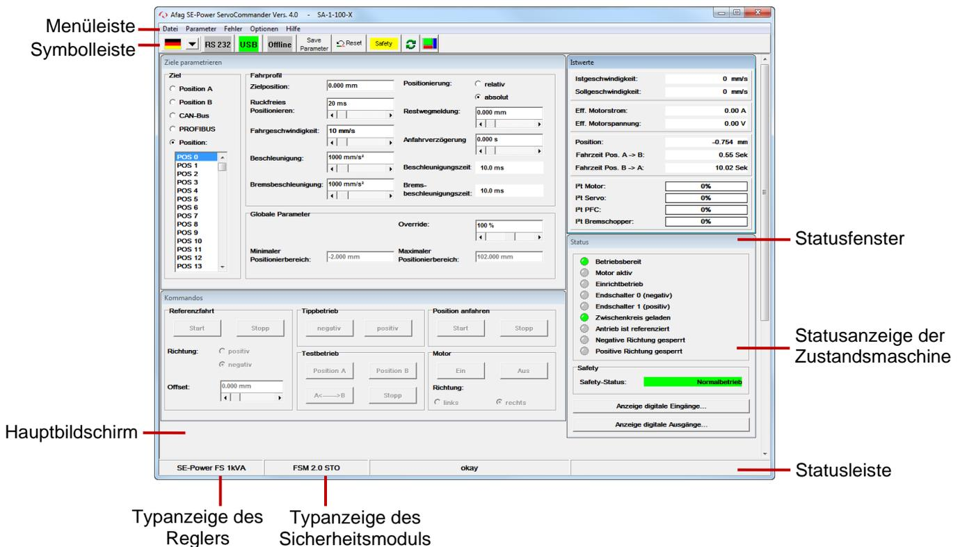
Abbildung 51: Typanzeige des Sicherheitsmoduls und erweitertes Status-Fenster
