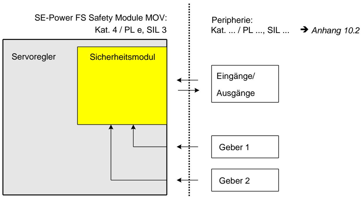
Abbildung 1: Sicherheitsniveau SE-Power FS Safety Module MOV und Gesamtsystem
