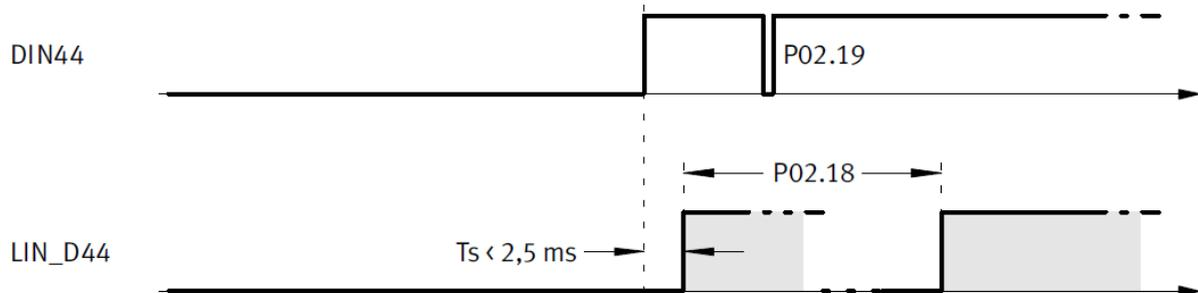
Abbildung 13: Timingdiagramm einkanaliger Eingang (Beispiel DIN44)
