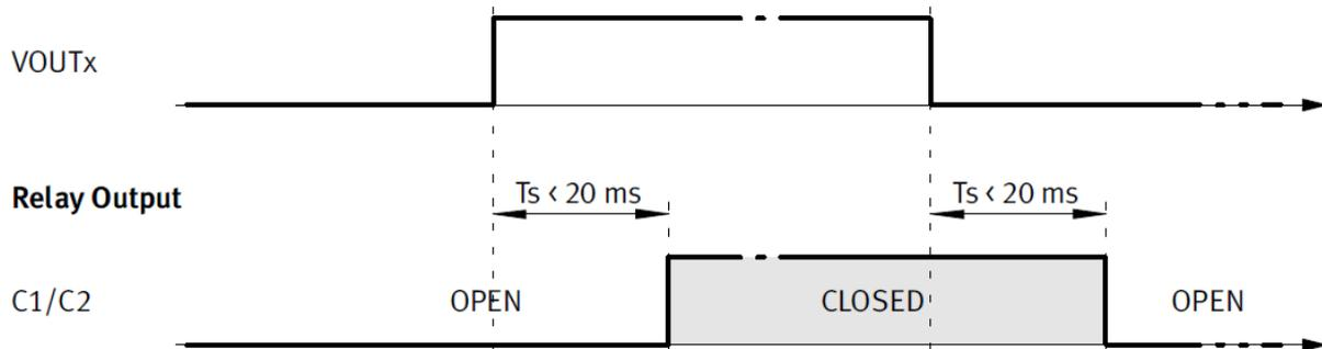
Abbildung 36: Timingdiagramm des potentialfreien Meldekontaktes
