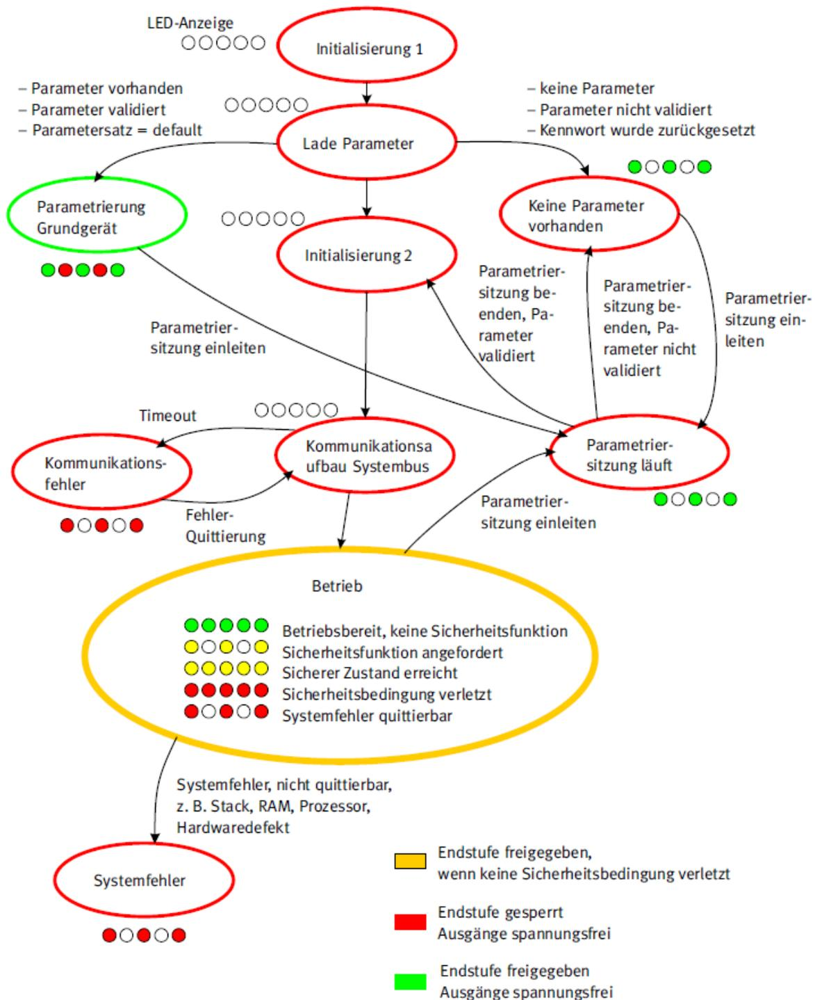
Abbildung 37: Zustände des „Gesamtsystems“
