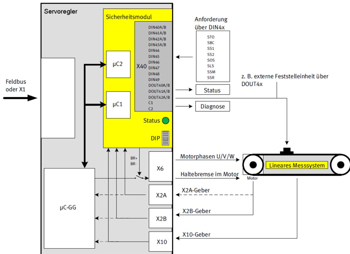
Abbildung 3: Funktionsprinzip Sicherheitsmodul
