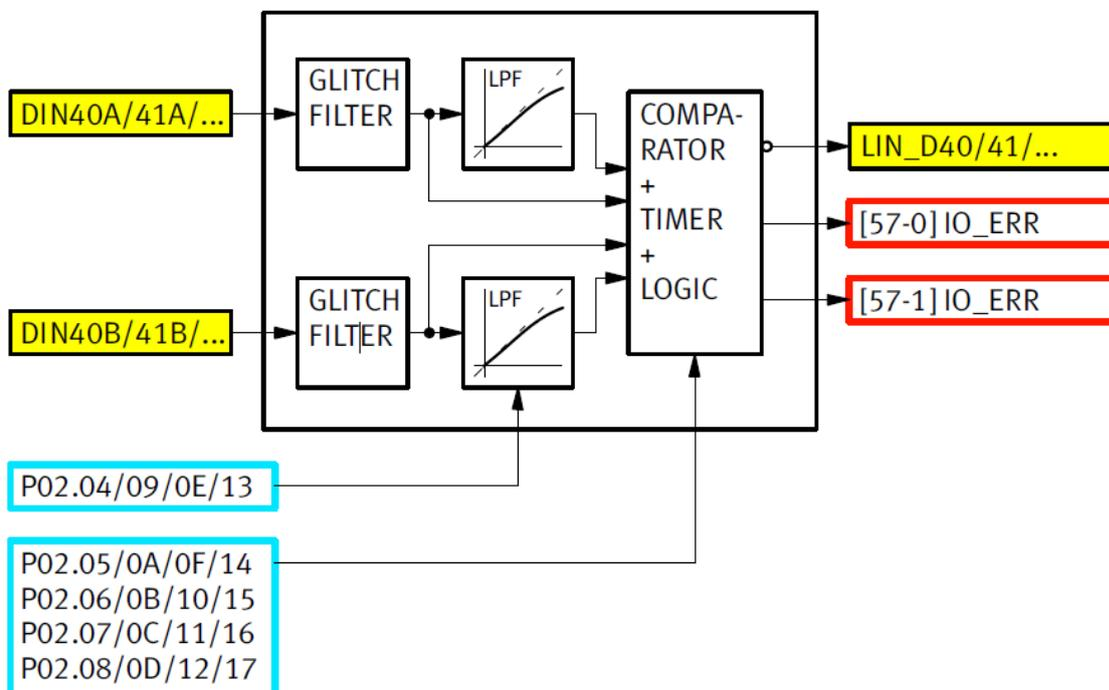
Abbildung 7: Blockschaltbild der zweikanaligen sicheren Eingänge
