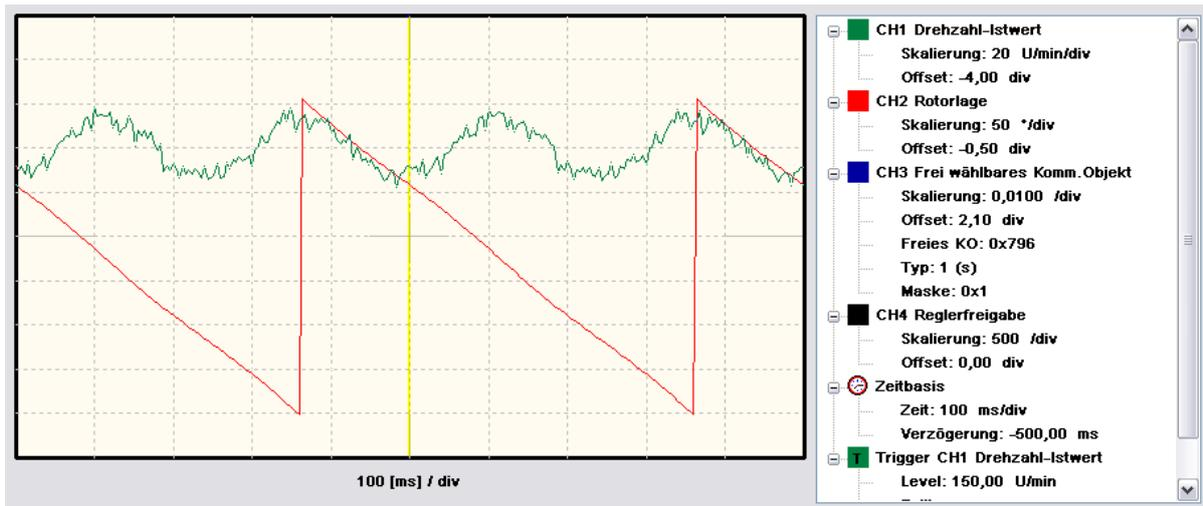
**Abbildung 70: Fehlerkurven auf dem Geschwindigkeitssignal (CH1) bei einer Verringerung der Signalamplitude von  $e_x$  um 10%. Es ergibt sich eine Drehzahlwelligkeit von ebenfalls 10%. Die Messung erfolgte bei Fremdantrieb der Welle mit konstanter Drehzahl.**
