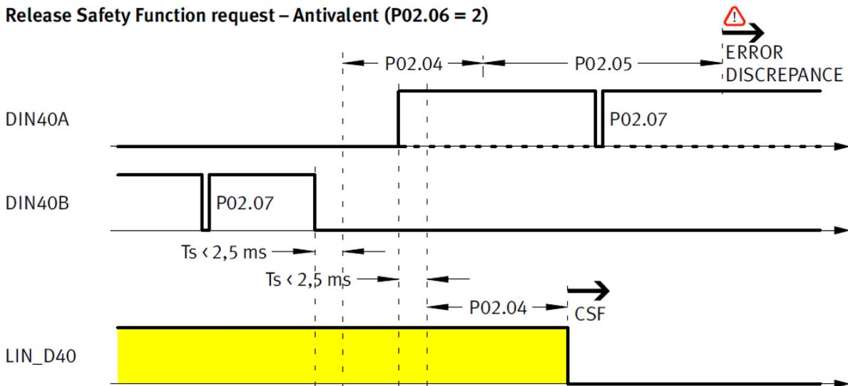
Abbildung 11: Timingdiagramm zweikanaliger sicherer Eingang Antivalent – Anforderung beenden (DIN40)
