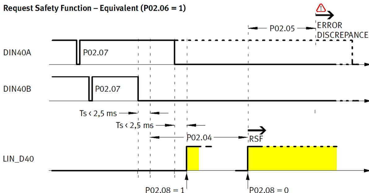
Abbildung 8: Timingdiagramm zweikanaliger sicherer Eingang Äquivalent – Anforderung starten (DIN40)
