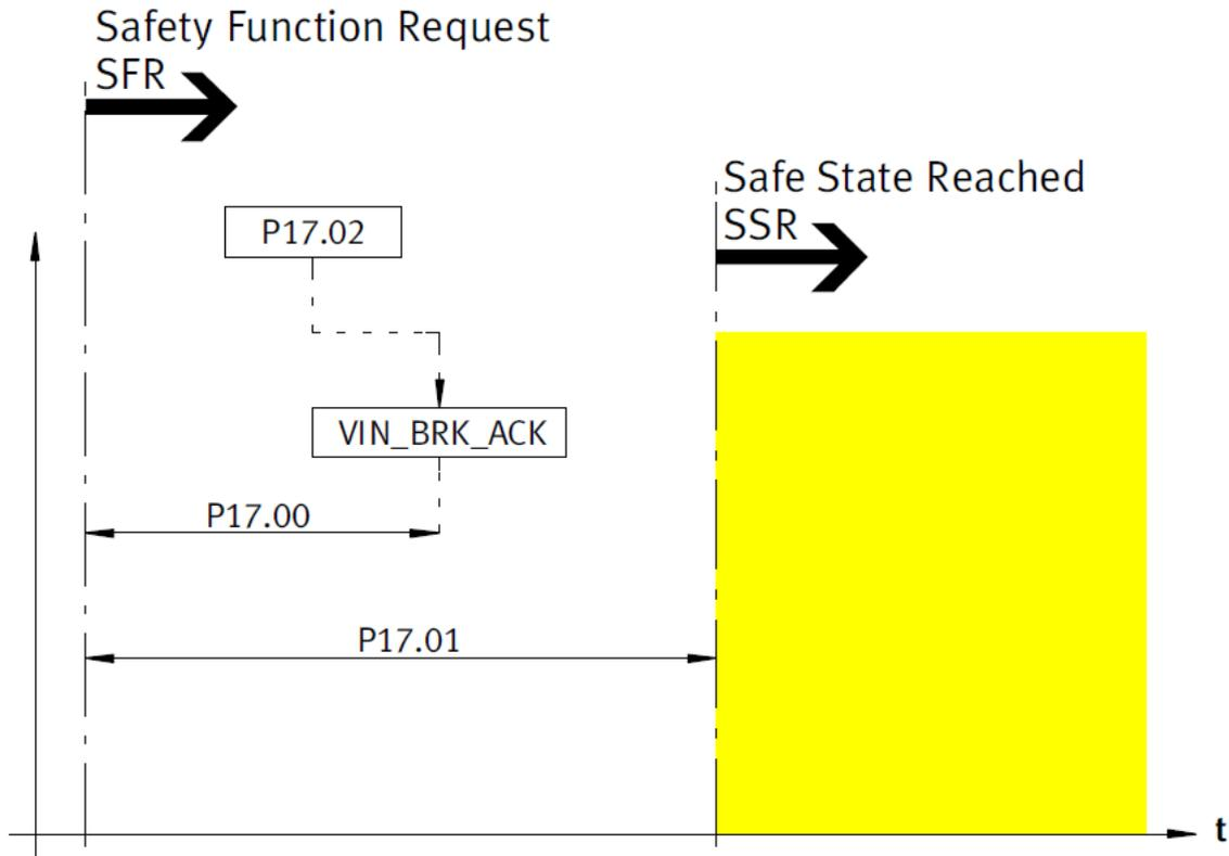
Abbildung 18: Ablaufdiagramm SBC
