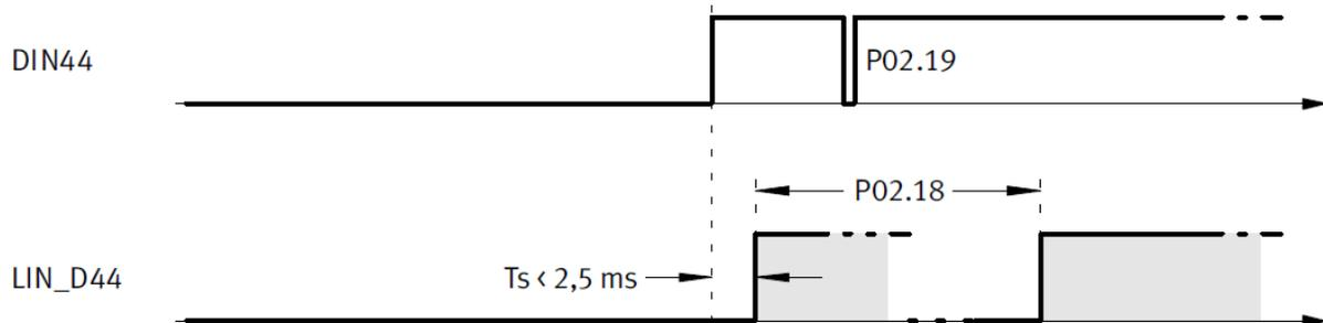
Abbildung 13: Timingdiagramm einkanaliger Eingang (Beispiel DIN44)
