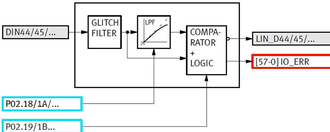
Abbildung 12: Blockschaltbild der einkanaligen Eingänge
