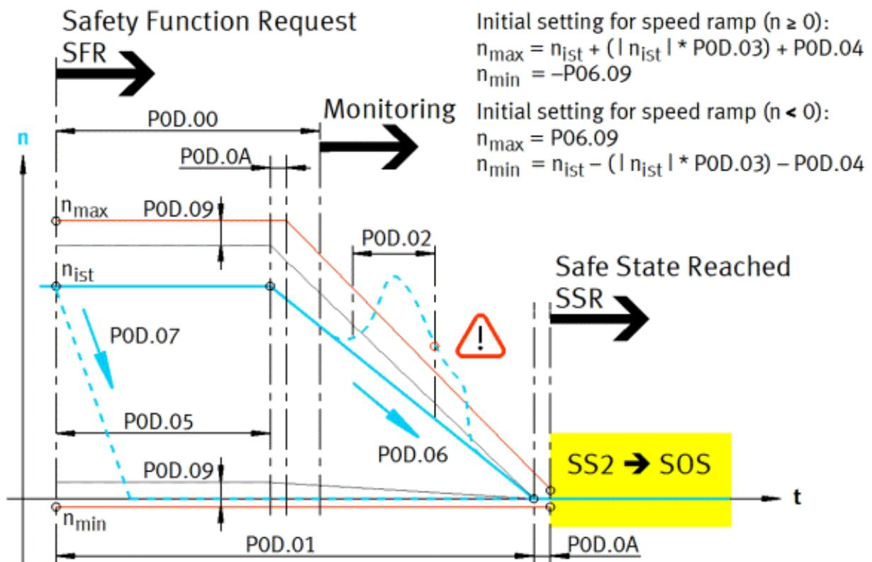
Abbildung 22: Ablaufdiagramm SS2
