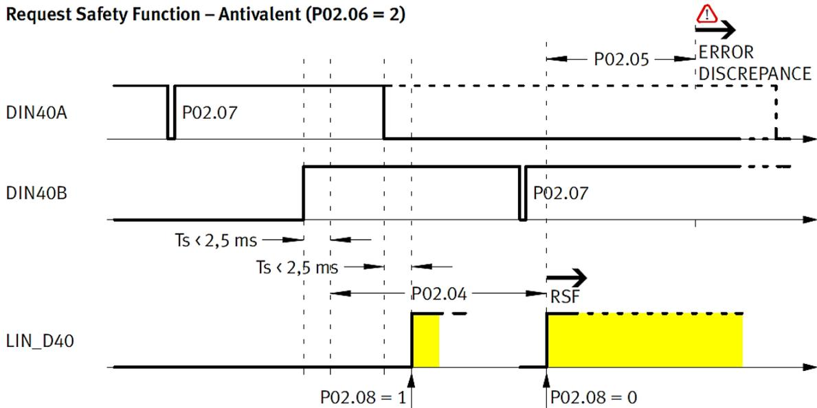
Abbildung 10: Timingdiagramm zweikanaliger sicherer Eingang Antivalent – Anforderung starten (DIN40)
