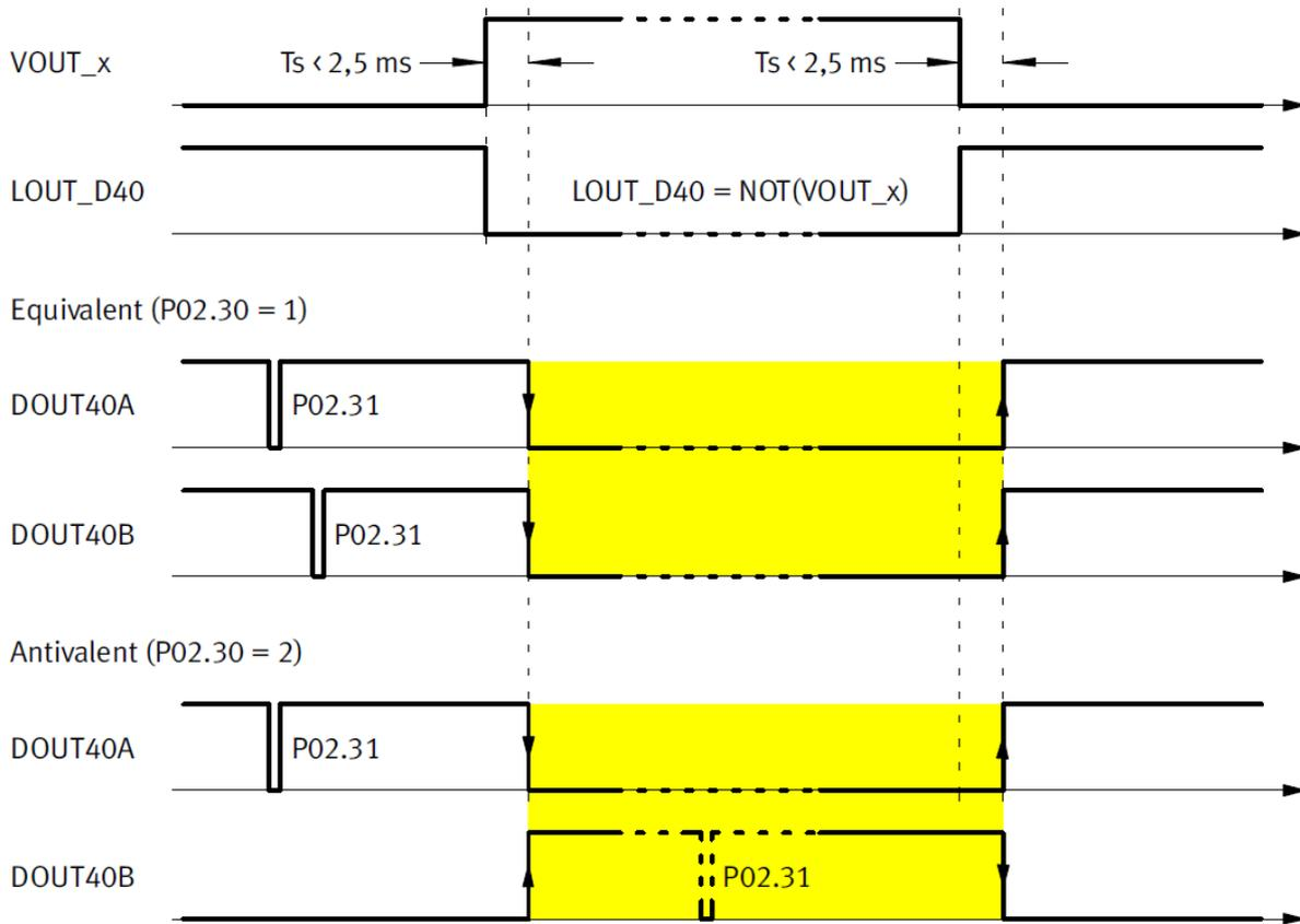
Abbildung 32: Timingdiagramm der zweikanaligen sicheren Ausgänge
