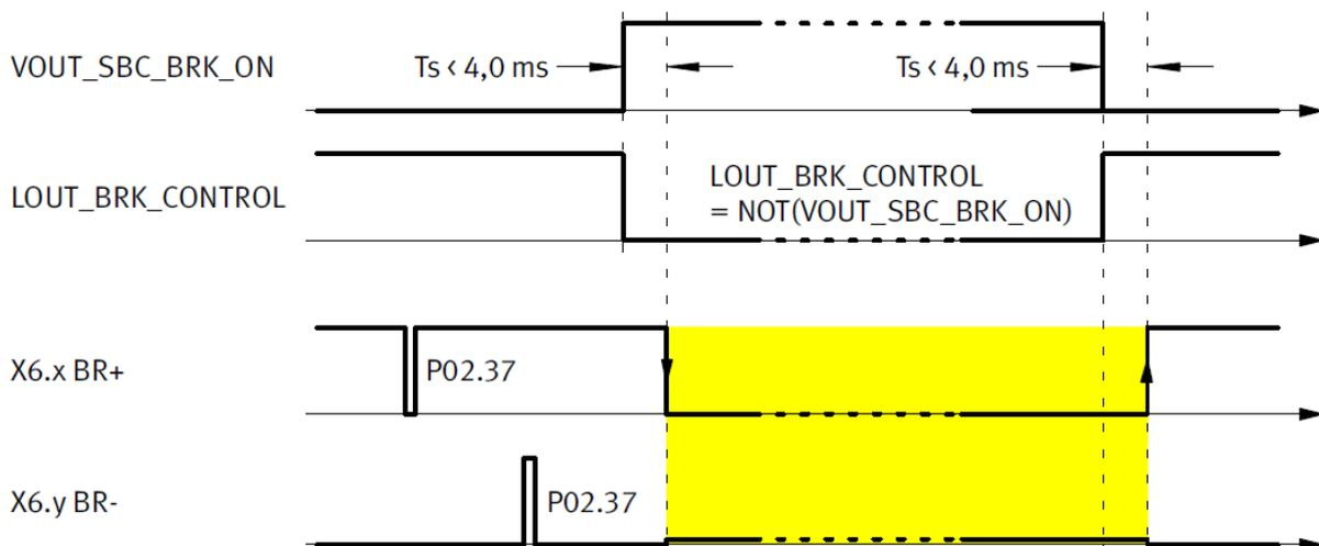
Abbildung 34: Timingdiagramm der integrierten Bremsansteuerung im Grundgerät
