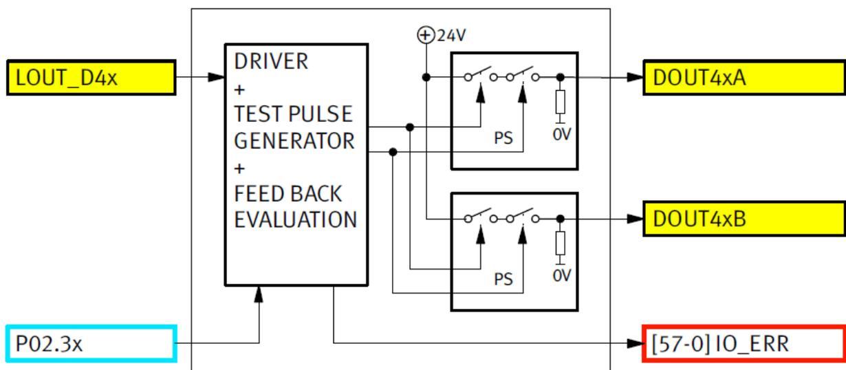
Abbildung 31: Blockschaubild der zweikanaligen sicheren Ausgänge
