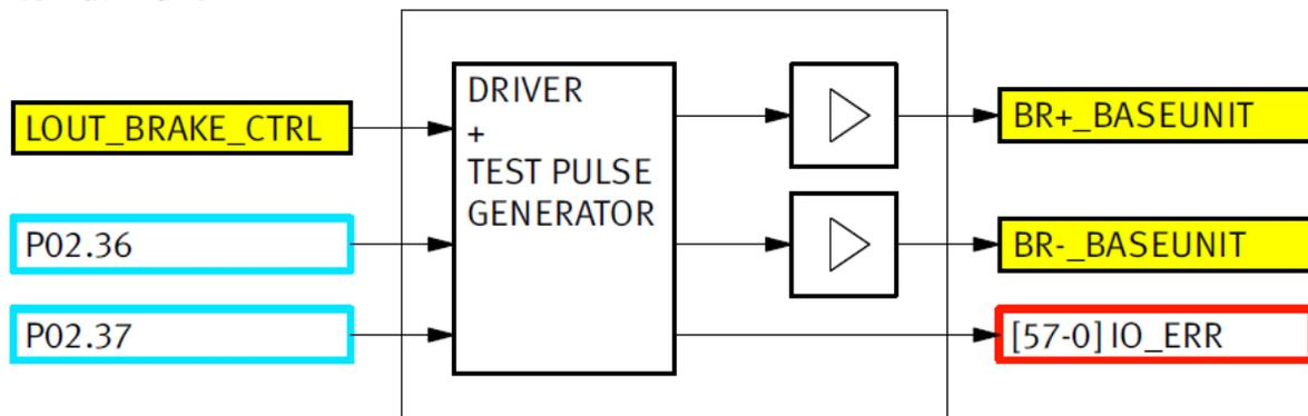
Abbildung 33: Blockschaltbild der sicheren Bremsansteuerung im Grundgerät
