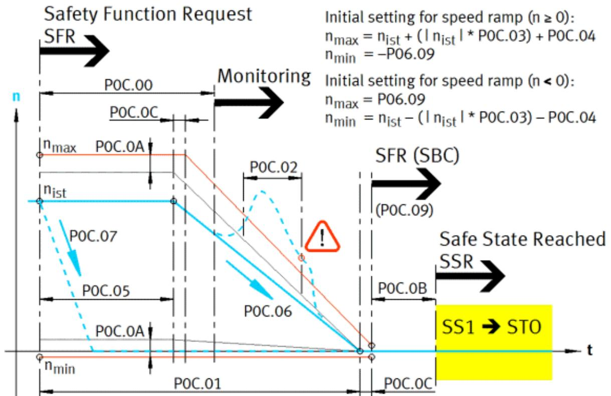
Abbildung 20: Ablaufdiagramm SS1
