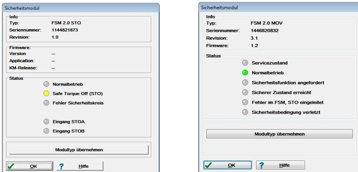
Abbildung 53: Fenster Sicherheitsmodul STO (links) und MOV (rechts)
