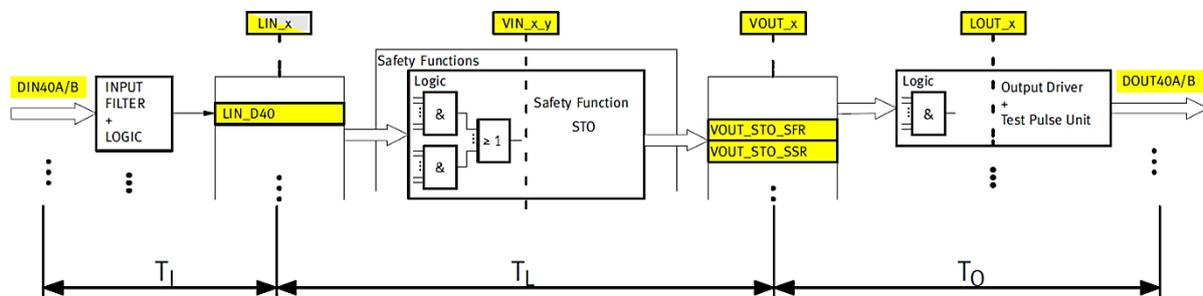
**Abbildung 40: Reaktionszeiten des Sicherheitsmoduls (schematische Darstellung, Ausschnitt aus *Abbildung 4*)**
