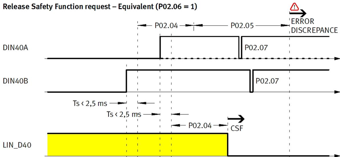
Abbildung 9: Timing Diagramm zweikanaliger sicherer Eingang Äquivalent – Anforderung beenden (DIN40)
