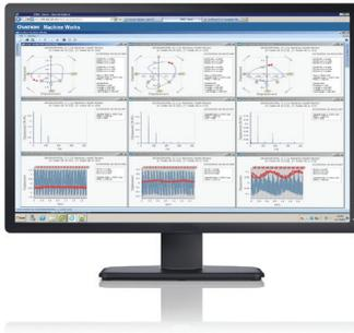
O aplicativo Machine Works da Ovation oferece aos operadores diagramas de diagnóstico para análise de vibração.
