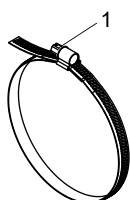
Fig. 6.44 : Bande de serrage avec fermoir de collier de serrage
