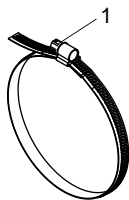
Fig. 6.19 : Bande de serrage avec fermetoir de collier de serrage
