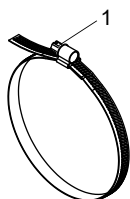
Fig. 6.50 : Bande de serrage avec fermoir de collier de serrage
