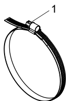
Fig. 6.25 : Bande de serrage avec fermoir de collier de serrage
