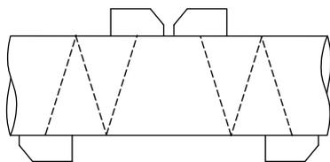
Fig. 3.7: Configuración en modo de reflexión con 1 haz y 4 trayectorias de sonido
