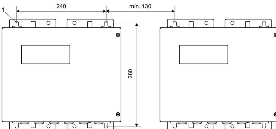
1 – orificios de fijación para el montaje en pared  $\varnothing$  9.5
