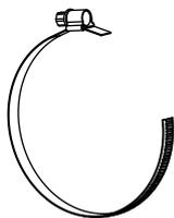
Fig. 6.40: Cinta de sujeción con cierre tensor rápido
