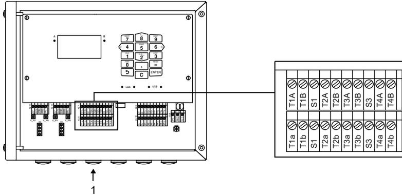
1 – conexión del sensor de temperatura
