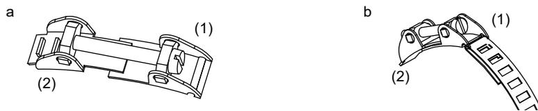
Fig. 6.62: Sensor de temperatura en la tubería
