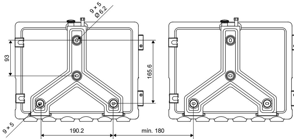
Fig. 6.5: Vista de montaje
