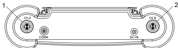
Fig. 7.16: Conexión de los transductores al transmisor
