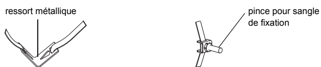
Fig. 9.23: Sangle de fixation avec ressort métallique et pince pour sangle de fixation
