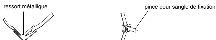
Fig. 9.15: Sangle de fixation avec ressort métallique et pince pour sangle de fixation
