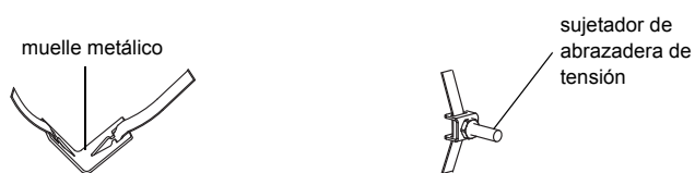
Fig. 9.23: Abrazadera de tensión con muelle metálico y sujetador de abrazadera de tensión
