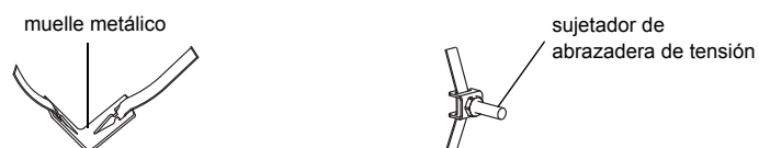
Fig. 9.15: Abrazadera de tensión con muelle metálico y sujetador de abrazadera de tensión
