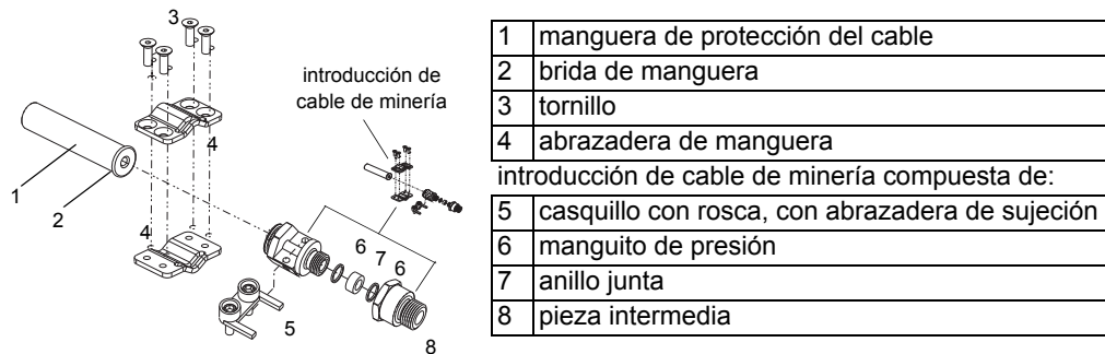
Fig. 8.3: Prensaestopas M16 de minería
